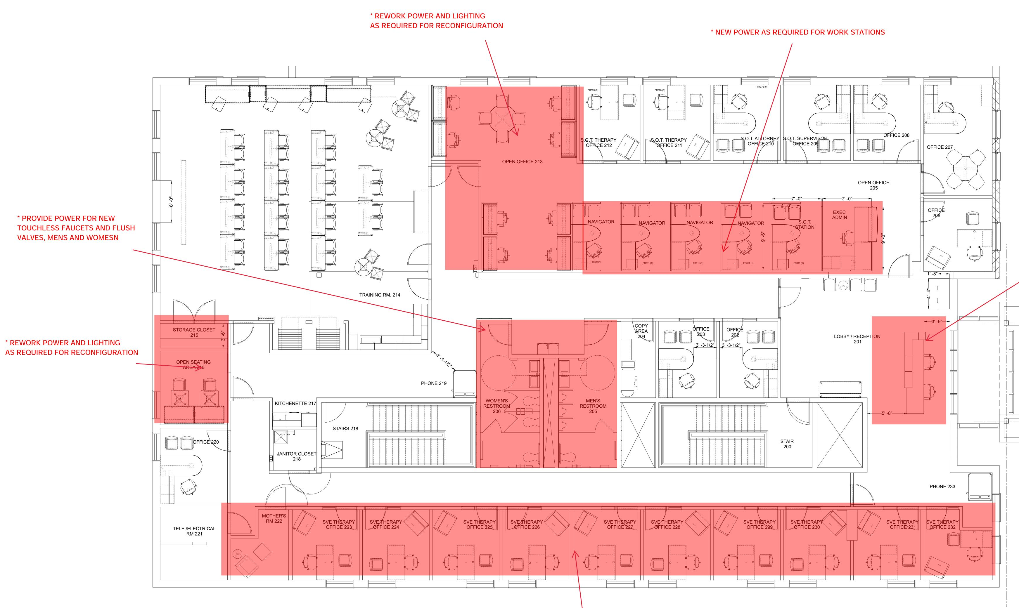
\* REWORK POWER AND LIGHTING AS REQUIRED FOR RECONFIGURATION
